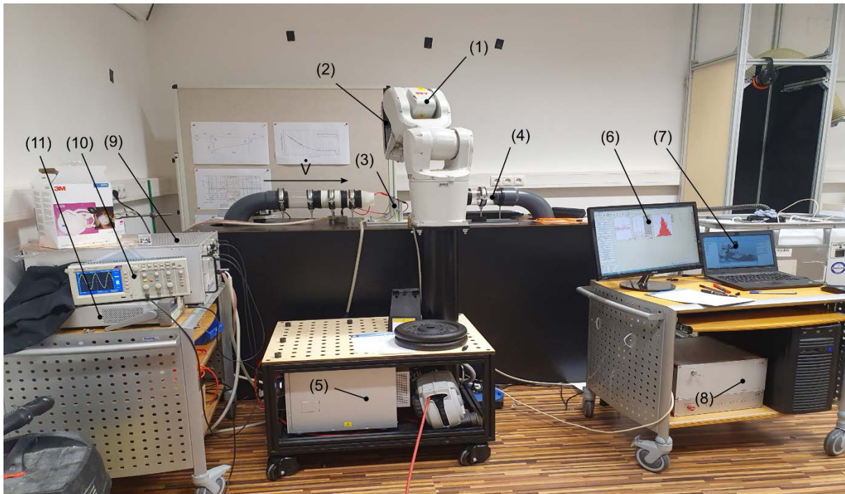
Abb. 1: Experimenteller Versuchsaufbau: (1) ... Roboter ABB IRB 1200 7kg 0.7m, (2) .... LDA ILA fp50-shifted, (3) ... 30° geneigte Platte, (4) ... offener Windkanal, (5) ... Robotersteuerungseinheit, (6) ... LDA Mess-PC (inkl. schwarzer Tower) , (7) Laptop mit RobotStudio® 2021 zur Robotersteuerung, (8) LDA Messauswerteeinheit (Hardwarefilter) und Versorgung für den Laser, (9) Hochspannungsquelle TRek 20/20C-HS, (10) Speicheroszilloskop Tektronix TDS 2002C, (11) Funktionsgenerator Agilent 33250A.
