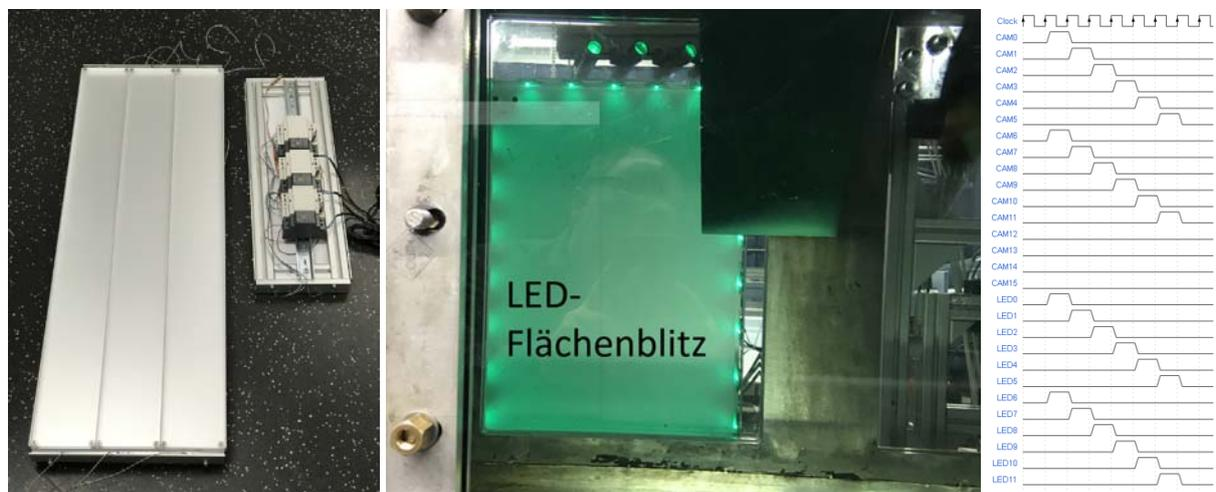
Abbildung 4: Realisierte LED-Flächenstrahler. Links: dreigeteilte Beleuchtung für K21, Mitte: Flächenstrahler im K15A, Rechts: Synchronisationsschema für Kameras und LEDs
