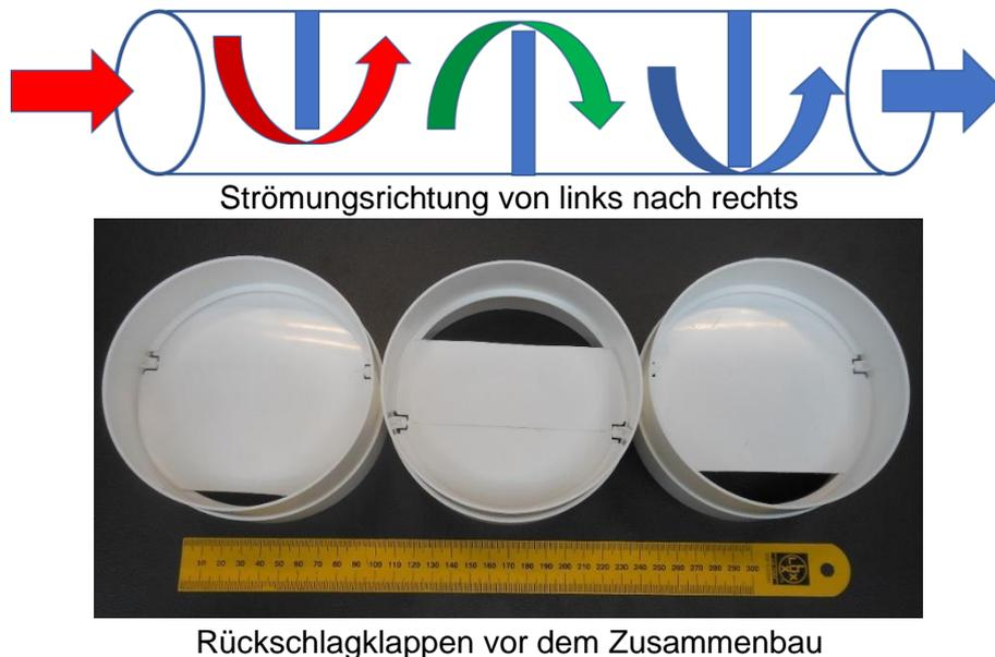
Abb. 4: Labyrinth zur Probenahme schematisch und verwendete Rückschlagklappen
