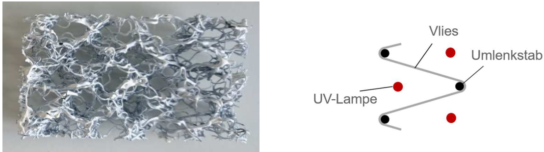
Abb. 1: Mit reaktiver Farbe beschichtetes Vlies (links) und Prinzip der zickzack-Anordnung (rechts).
