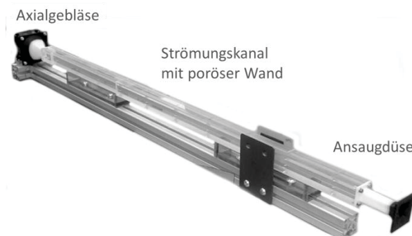
Abb. 5: untersuchter Strömungskanal mit optischer Zugänglichkeit und einer Wand mit innen aufgebrachtem Metallschaum
