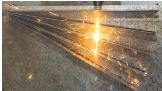
Abb. 2: Fächeranordnung von mittels Laser zu schneidenden Blechen (vgl. z.B. Hennigs et al. 2018).
