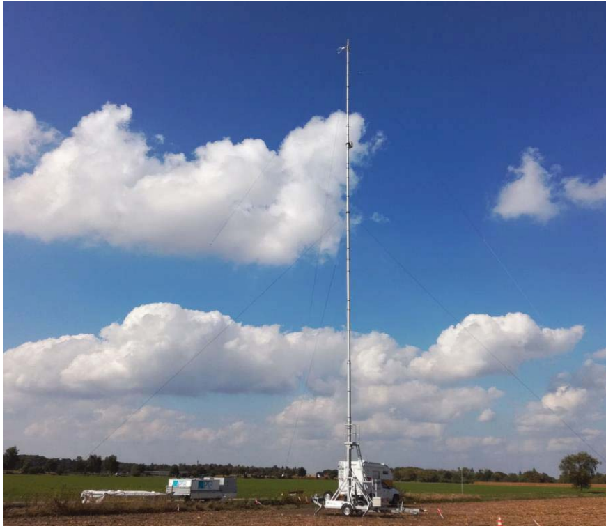
Abb. 1: Wind-Lidar der PTB (links) und 30 m Messmast mit Ultraschallanemometer (rechts), die Kamera blickt in Richtung Nord-West.
