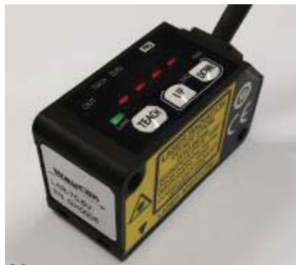
Abb. 3: Laserabstandssensor zur Messung der Grenzflächenauslenkung.
