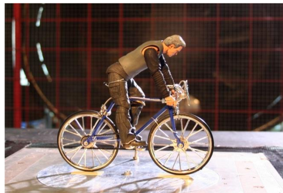
Abb. 2: Splitterplatte mit eingelassener Kraftmesswaage und montiertem Fahrradfahrermodell in der Testsektion des Windkanals Göttinger Bauart.
