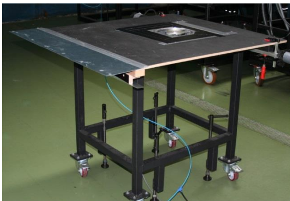
Abb. 2: Splitterplatte mit eingelassener Kraftmesswaage und montiertem Fahrradfahrermodell in der Testsektion des Windkanals Göttinger Bauart.
