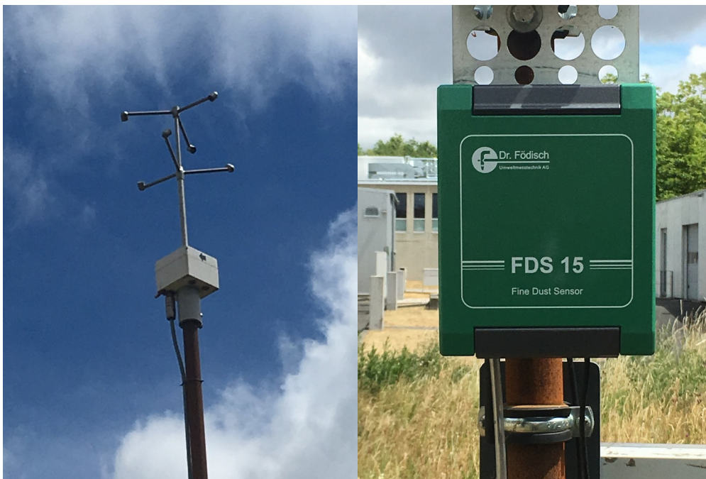
Abbildung 2: links: 3D-Ultraschallanemometer uSonic-3 Scientific der Firma METEK, rechts: Feinstaubsensor FDS15 der Firma Dr. Födisch Umweltmesstechnik AG
