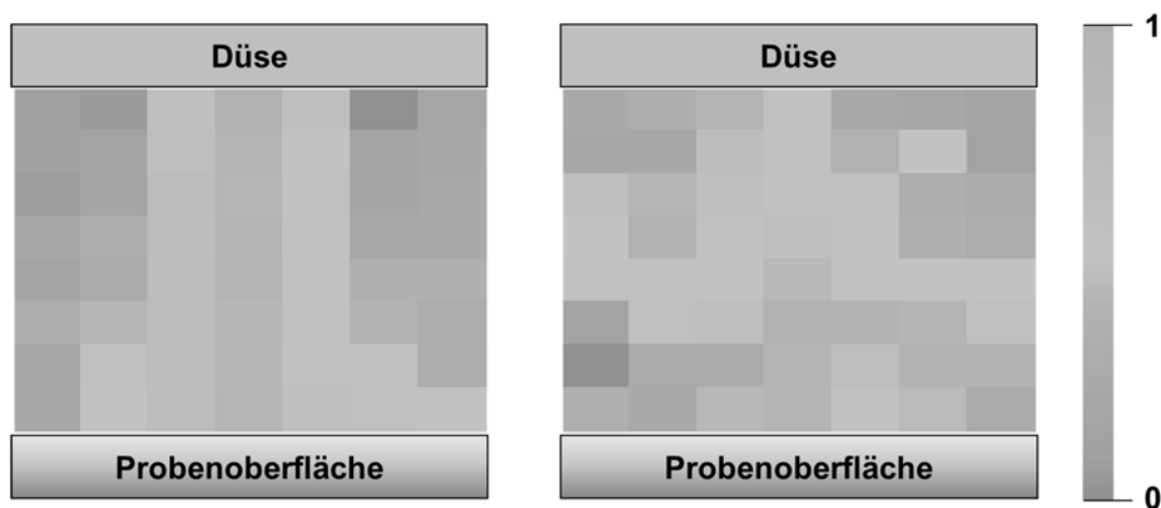
Abb. 6: Darstellung der betragsmäßig normierten mittleren Partikelgeschwindigkeiten zwischen der Düse und der Probenoberfläche nach den Schattenbildaufnahmen (links) und PIV-Aufnahmen (rechts).
