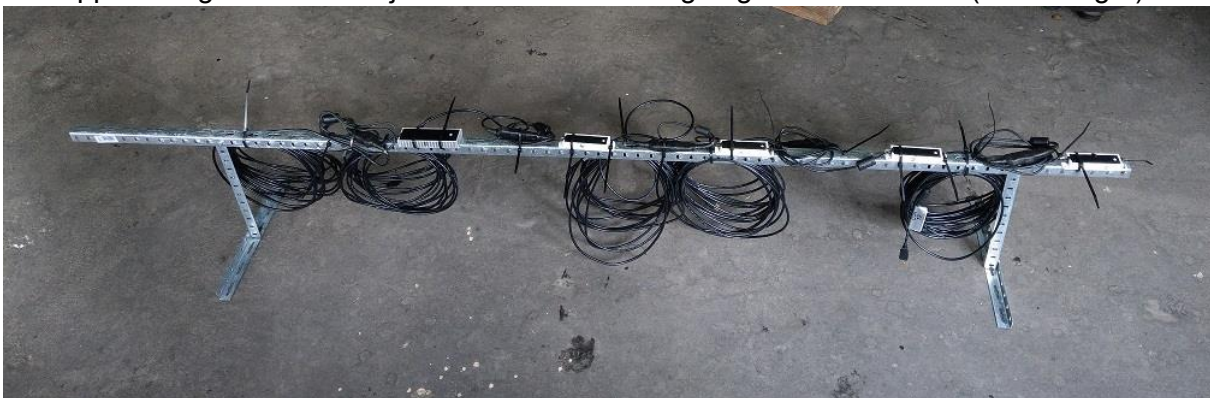
Abbildung 4: Messkette mit den fünf Drucksensoren
