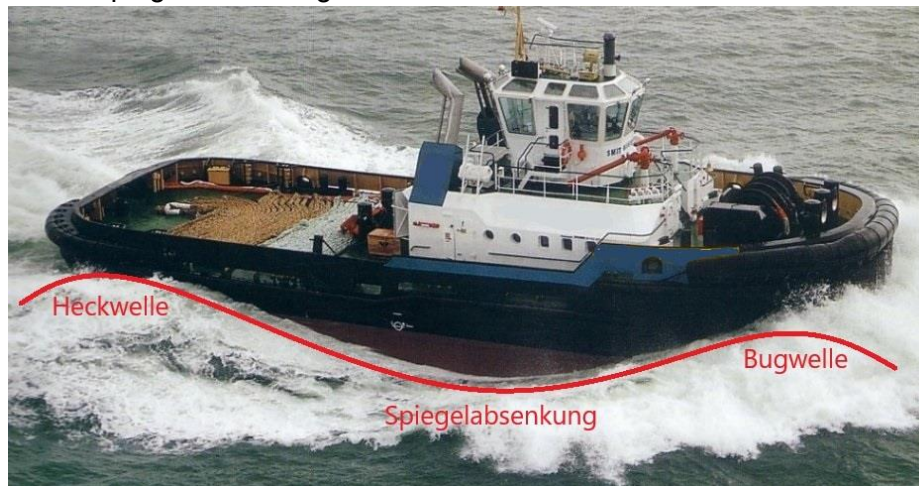
Abbildung 1: Primärwellenbild eines fahrenden Schiffes
