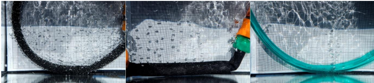
Abbildung 5: Unterschiedliche Schläuche als Luftinjektoren
