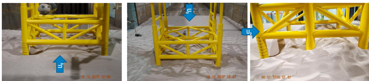
Abb.9: Kolkbildung an einem Jacket-Modell im FFF
