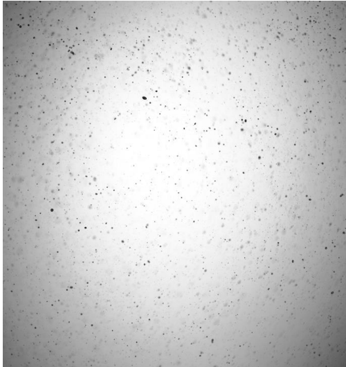
Abb. 6: Betrachtung der Tropfengröße der Flachstrahldüse mit einem Düsenauslassdurchmesser von 0,38 mm in einem Abstand von 20 mm zur Düse. Auf der linken Seite ist ein Ausschnitt des am Prüfstand aufgenommene Bild zu sehen, auf dessen Basis eine Analyse erfolgt. Die rechte Seite zeigt im Diagramm auf der x-Achse die Tropfengröße in \mu\text{m} , auf der y-Achse die normalisierte Tropfenanzahl. Die Balken stellen hierbei ein Histogramm dar, die Kennlinie den kumulierten Prozentsatz der Tropfen.
