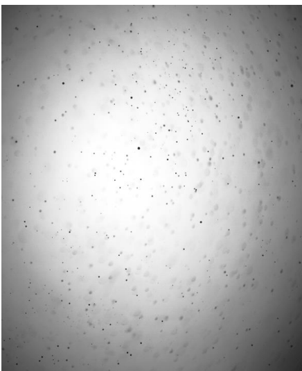
Abb. 7: Betrachtung der Tropfengröße der Flachstrahldüse mit einem Düsenauslassdurchmesser von 0,38 mm in einem Abstand von 600 mm zur Düse. Die linke Seite zeigt auch hier das aufgenommene Bild, während die rechte Seite analog zu Abbildung 6 eine Übersicht über die Tropfengröße gibt.
