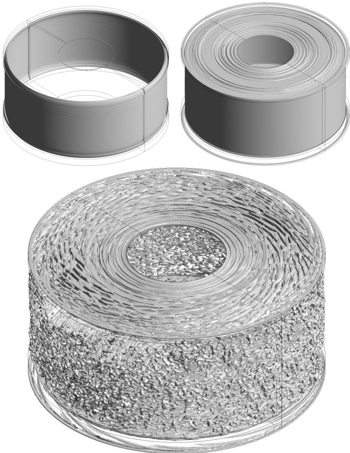
Abb. 7: Isoflächen des Q-Kriteriums bei 120 U/min (oben links), 600 U/min (oben rechts) und 3000 U/min (unten)
