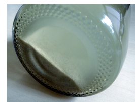
Abb. 9: Bestimmung der maximalen Hangneigung
