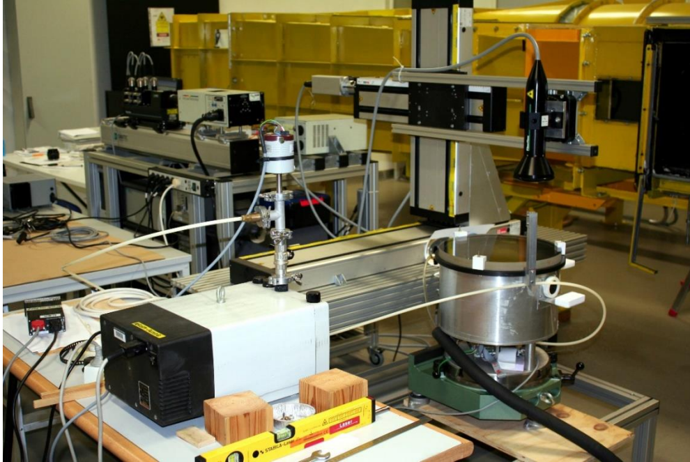
Abbildung 3. Experimentelle Anlage zur Untersuchung des Strömungsfeldes in der MOL-Messkammer.
