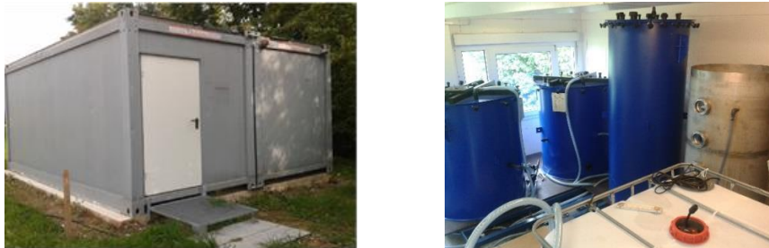
Abbildung 1: Dezentrale Brauchwasserbereitungsanlage im halbtechnischen Maßstab. Die Aufstellung erfolgte auf dem Gelände der kommunalen Kläranlage in Erlangen (Bayreutherstraße 105, 91054 Erlangen)
