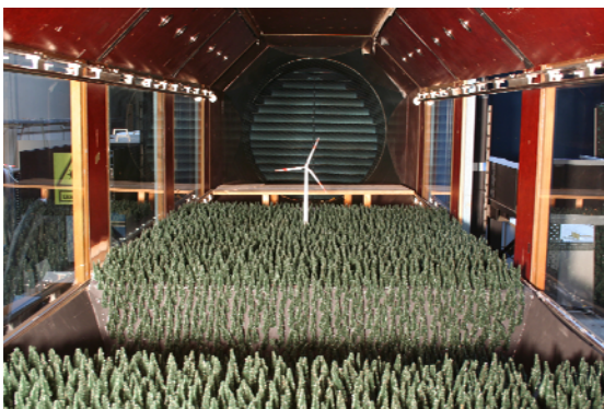
Abb. 1: Foto eines in den atmosphärischen Grenzschichtwindkanal eingebauten Tals
