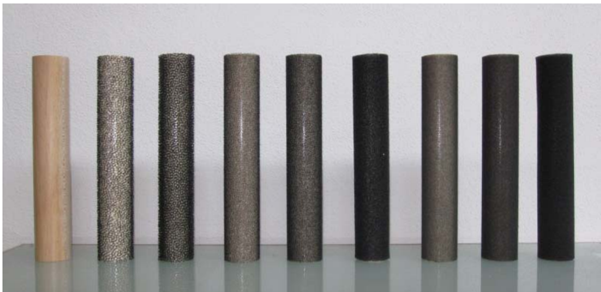
Abb. 6: Voll (porös) ummantelte Zylindermodelle
