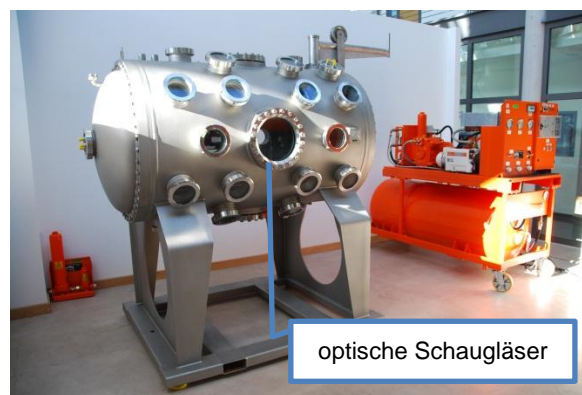
Abb. 1: Druckbehälter (links) und \text{SF}_6 -Versorgungseinheit (rechts)
