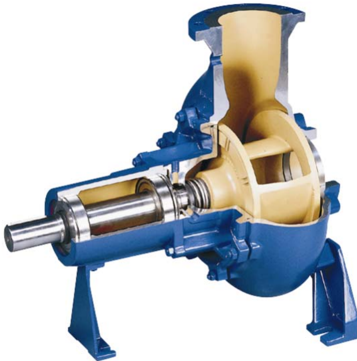
Bild 1: Einstufige Abwasserpumpe mit Einschau- felrad für Trockenaufstellung
