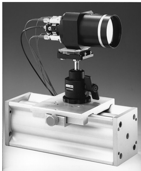
Abb. 5: Fasergekoppelter 2K-LDA-Messkopf für einen Arbeitsabstand von 300 mm mit eingebauter Streulichtempfangsoptik
