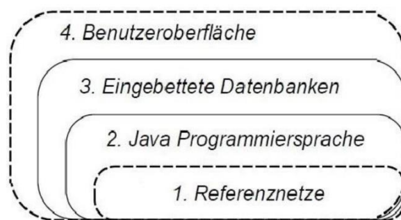
Abbildung 1: Grundarchitektur des Simulationskonzeptes, das sich in vier Ebenen gliedert.
