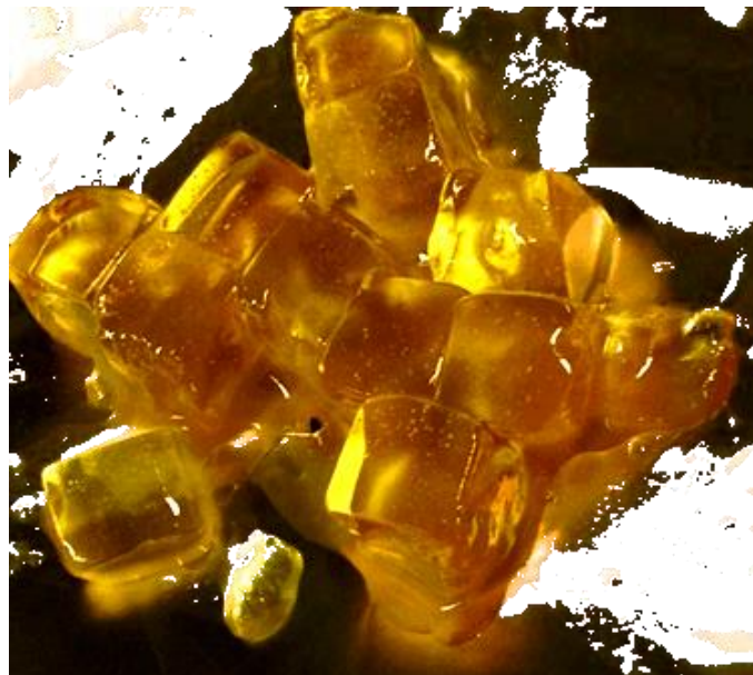
Abb. 5: Partikel aus einem Hydrokolloidgele, dessen Brechungsindex mit Natriumiodid auf ca. 1,49 eingestellt wurde (0,8%w/w \kappa -Carrageenan).
