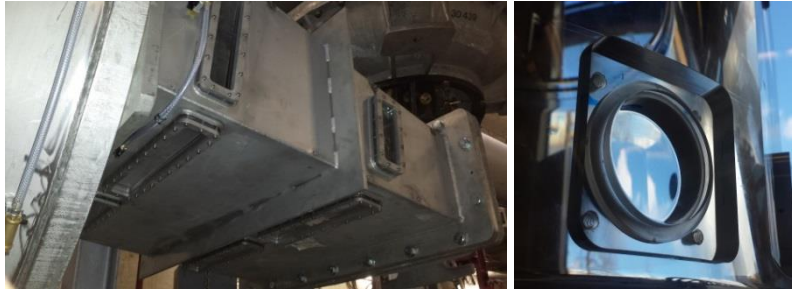
Abb. 2: Plexiglasfenster im Diffusor (links) und Konus (rechts) des Saugrohres
