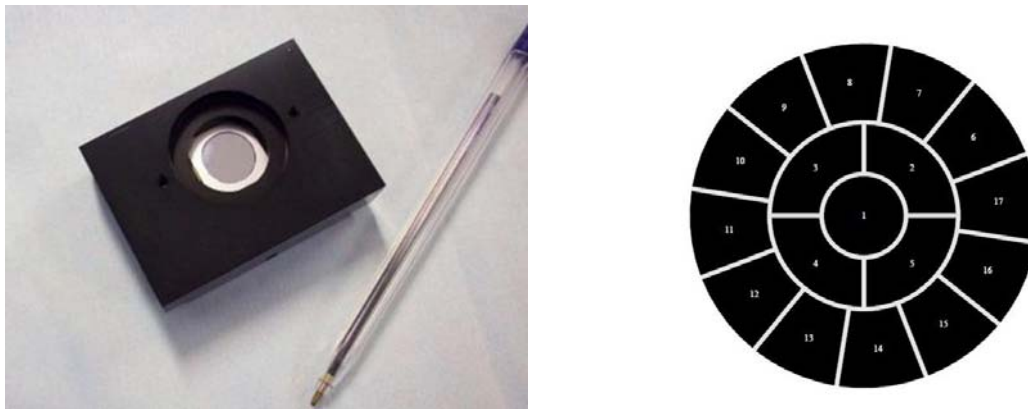
Abb. 1: Links: Zur Wellenfrontkorrektur eingesetzter deformierbarer Spiegel mit neuartiger Kipp-/Neigefunktion. Rechts: Aufteilung des Spiegels in 17 Segmente, die individuell angesteuert werden.
