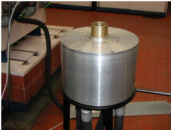
Bild 1: „Movable-Block“ - Brenner und Schnittebene in der Drallerzeugungseinheit
