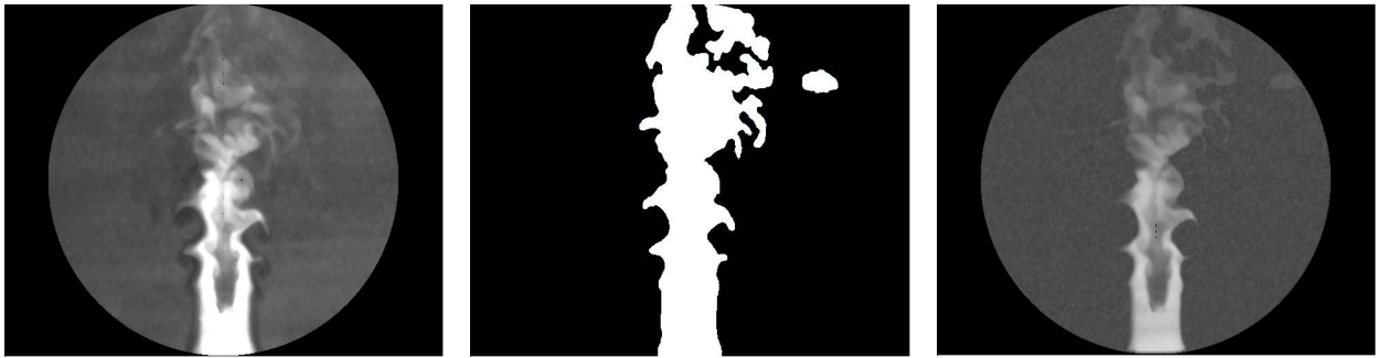
Abb. 4 Synthetische Bild-Generierung: Original Bild (links), Maske für die LIF Struktur (mitte) und synthetisches Bild mit Hintergrund-Wichtung von 40% (rechts)
